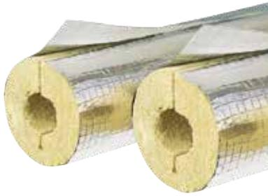
Isolierschale mit Oberflächenbeschichtung aus gitternetzverstärkter Aluminiumfolie und selbstklebender Überlappung, einseitig geschlitzt, Schalenlänge: 1 m, obere Anwendungsgrenztemperatur: 250 °C
