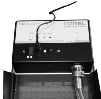
Die Leckpumpe ist jetzt immer einsatzbereit, solange 220V Spannung am Netzstecker des Netzteiles anliegt. Sollte die 220V Netzspannung ausfallen, läuft die Leckpumpe im Akkubetrieb weiter. Es gelten dann dieselben Einsatzbereitschaftsangaben für den netzlosen Akkubetrieb. Ist der Netzausfall vorbei, läuft die Pumpe wieder über 220V Netzspannung. Solange die Pumpe nicht läuft wird der Akku wieder, falls notwendig, geladen.
